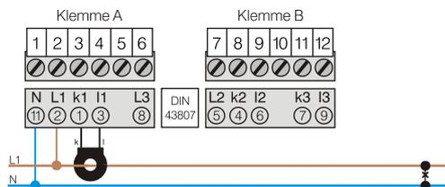
Bild 1. Anschluss mit Stromwandler
